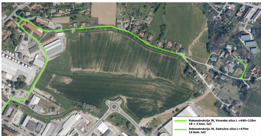
SLIKA 3: PREDMET UREJANJA – JAVNA RAZSVETLJAVA VINARSKA – MARIBORSKA CESTA
