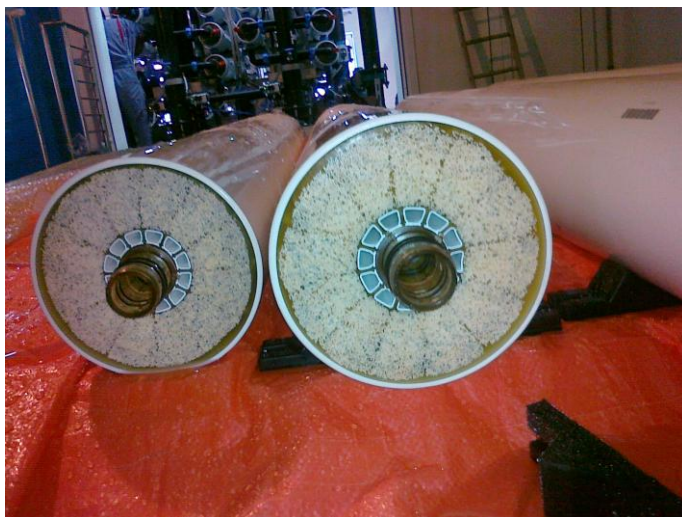
Slika 18: Modulni sistem UF naprave
